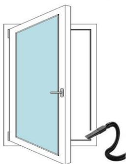
È importante ispezionare periodicamente l'interno del serramento per verificare che non ci siano corpi estranei o residui nelle guide e nelle fessure del serramento stesso.
